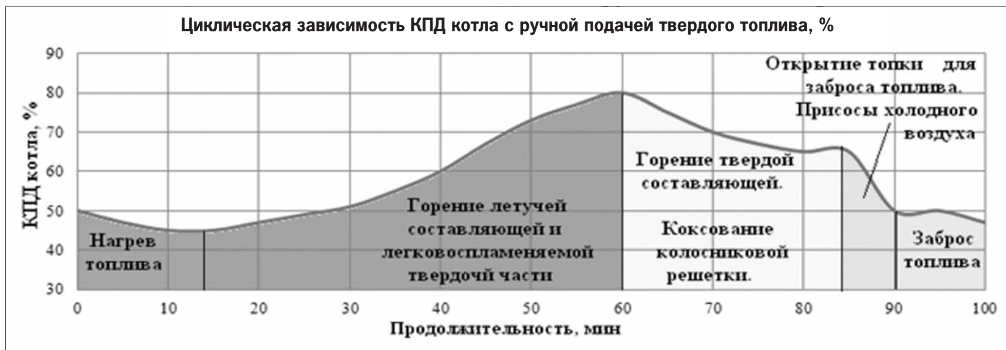
Рисунок 12.12. Циклическая зависимость КПД котла с ручной подачей топлива
