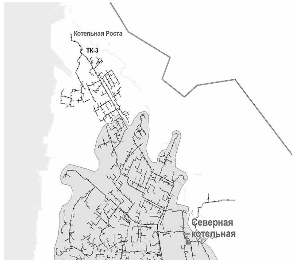
Рисунок 7.14 Путь для построения пьезометрического графика от кот. «Северная» до ТК-3 (перспективное положение, 2029 год)
