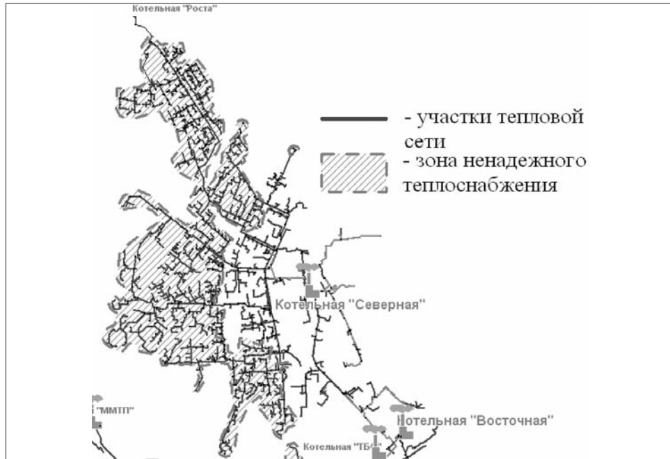
Рисунок 9.17 – Зона ненадежного теплоснабжения потребителей от Северной котельной
