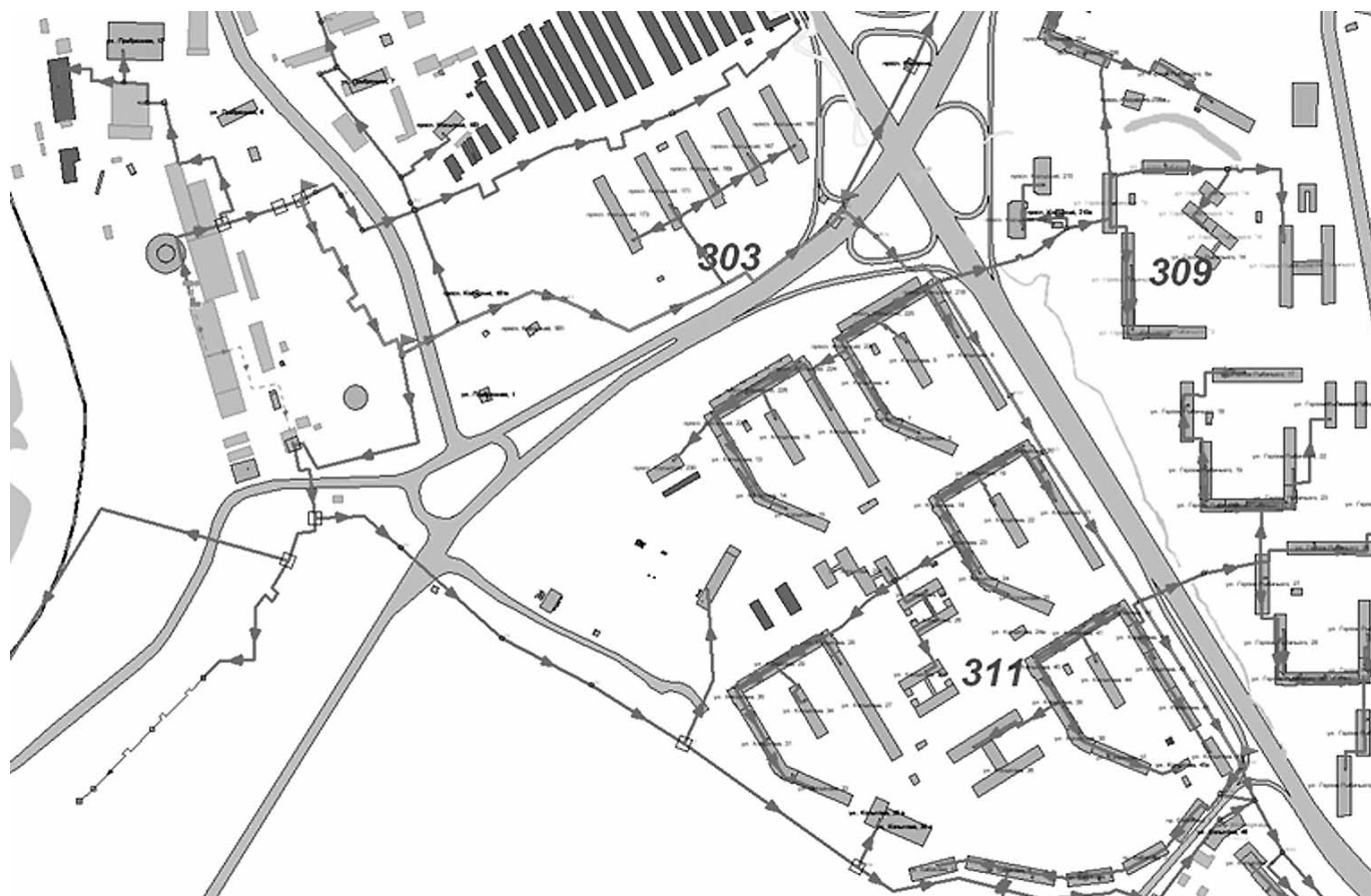
Рисунок 4 – Схема прокладки тепломагистрالی «Луч 2» Южной котельной
