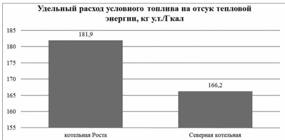
Рисунок 12.8. Удельные расходы топлива на Котельная «Северная» и котельной «РОСТА»
