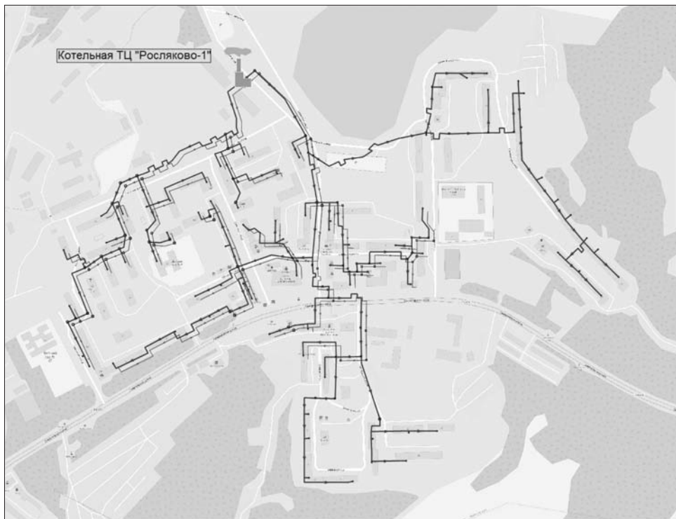
Рисунок 9.23 – Расчетная схема зоны теплоснабжения потребителей от котельной ТЦ «Росляково-1»
