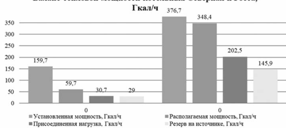
Рисунок 12.9. Баланс тепловой мощности котельных Северная и «РОСТА»
