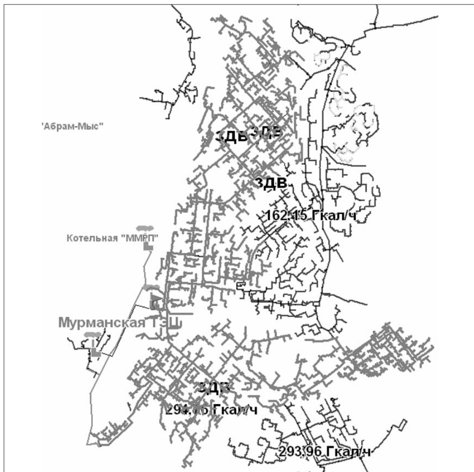
Рисунок 9.2 – Расчетная схема зоны теплоснабжения потребителей от Мурманской ТЭЦ
