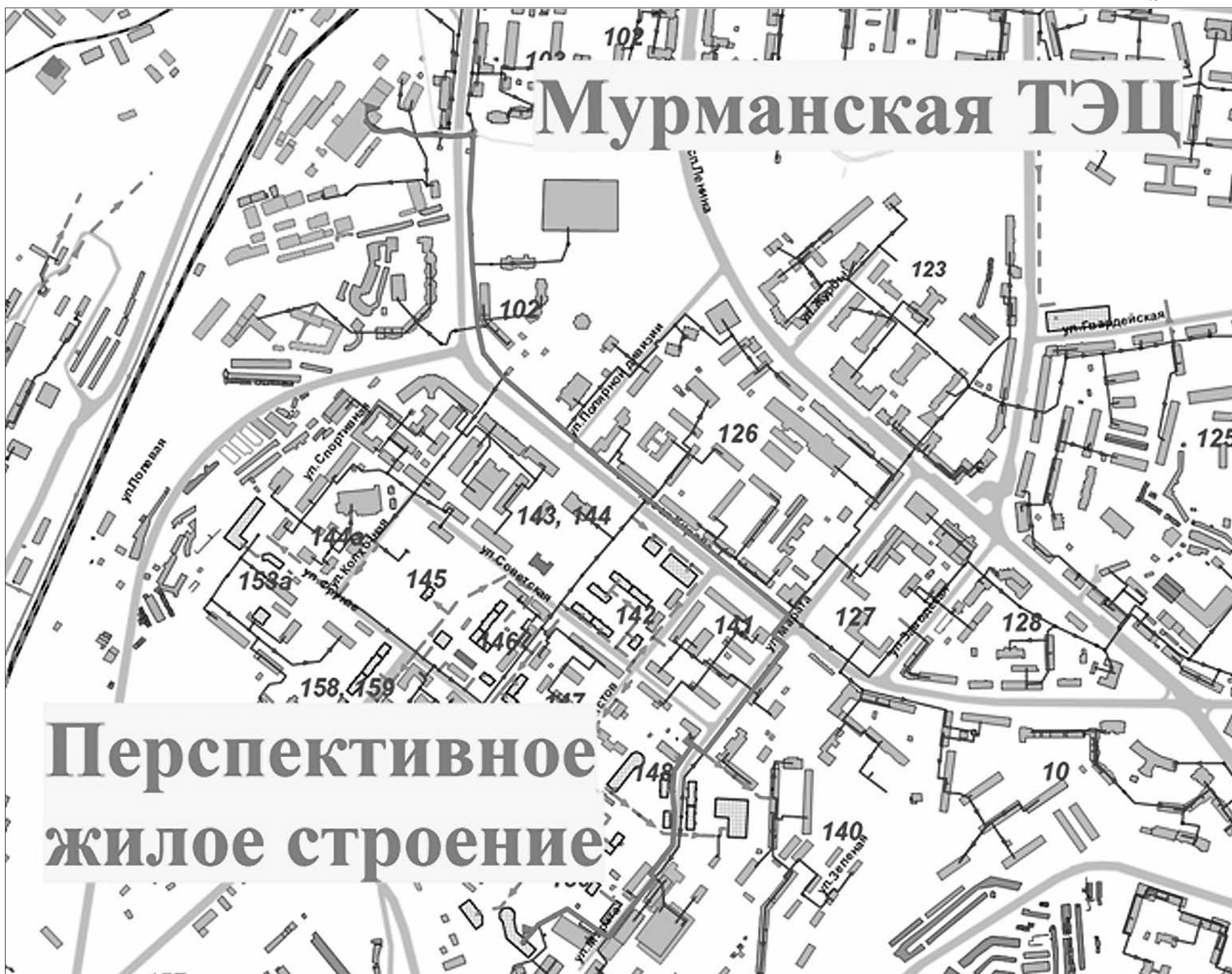
Рисунок 4.3 - Путь для построения пьезометрического графика от МТЭЦ до перспективного потребителя по ул. Марата
