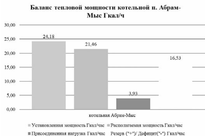
Рисунок 6.18 - Баланс тепловой мощности котельной п. Абрам-Мыс
