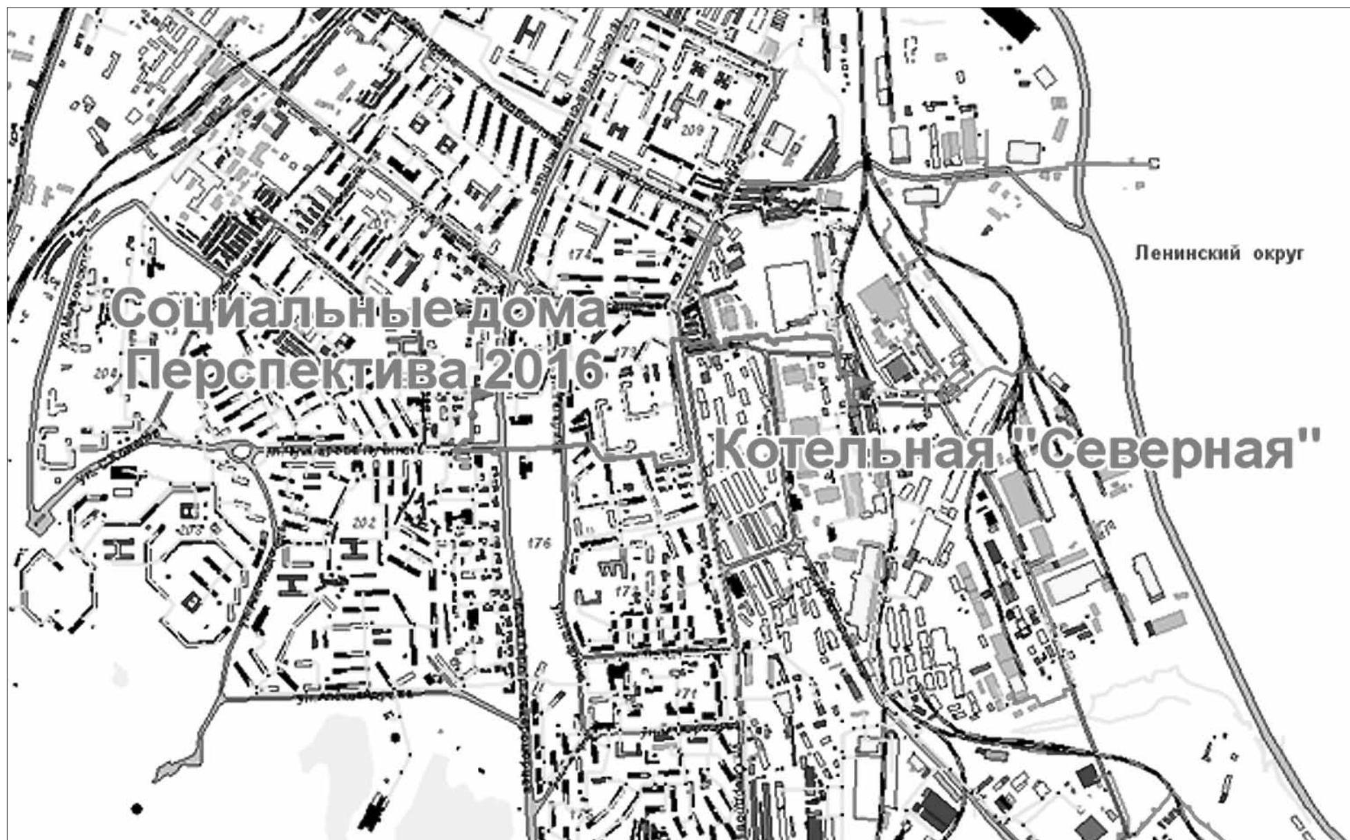
Рисунок 4.15 - Путь для построения пьезометрического графика от котельной Северная до перспективного потребителя в районе ул. Калинина
