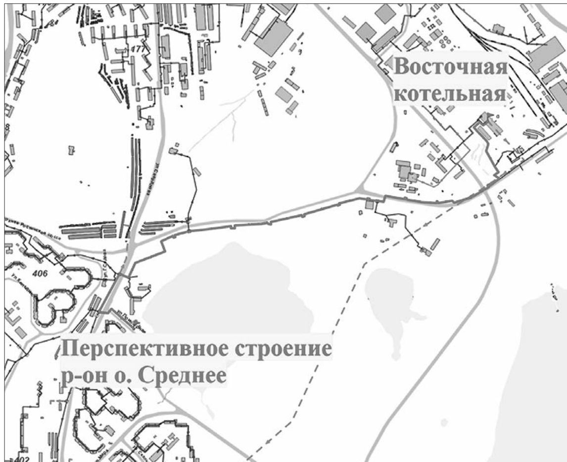
Рисунок 4.11 - Путь для построения пьезометрического графика от Восточной котельной до перспективного потребителя в районе оз. Среднее
