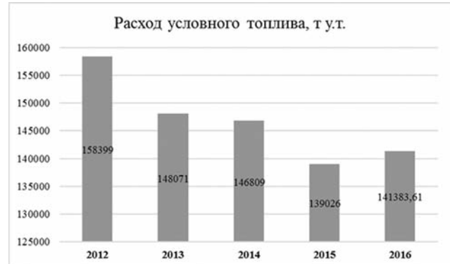
Рисунок 1.68. Расход условного топлива на Южной котельной
