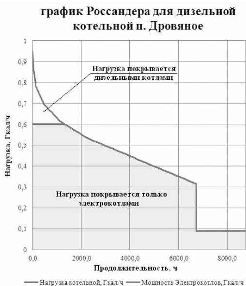
Рисунок 6.16 - График Россандера при работе электродкотлов
