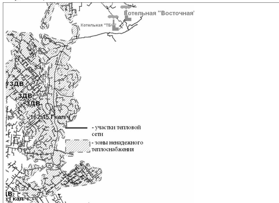
Рисунок 9.13 – Зона ненадежного теплоснабжения потребителей от Восточной котельной
