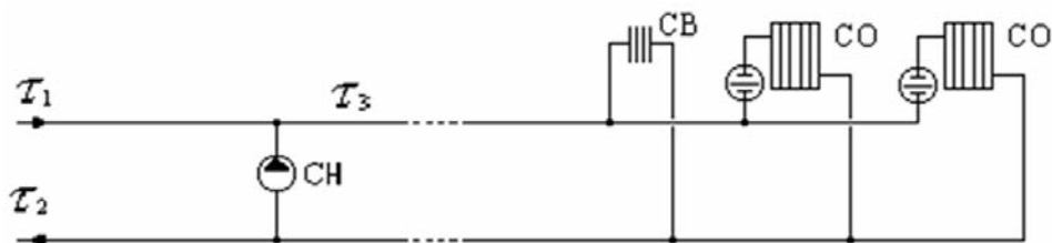
Схема 7 - ЦТП с насосным смещением на СО и СВ
