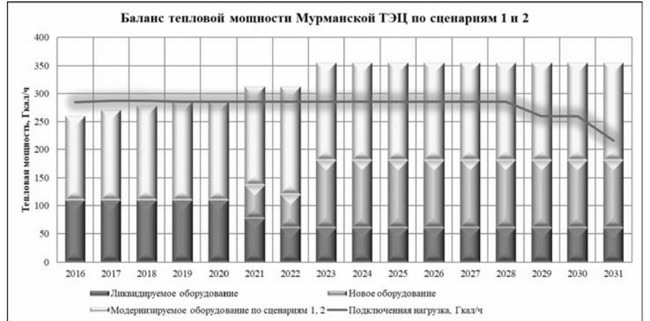
Рисунок 6.9 - Баланс тепловой мощности Мурманской ТЭЦ на период актуализации схемы теплоснабжения
