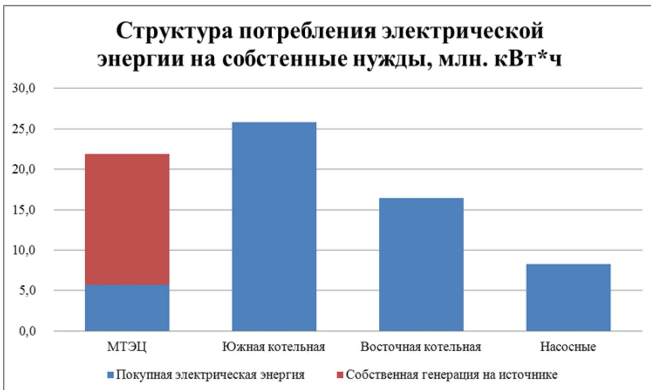
**Рисунок 12.3. Структура потребления электрической энергии на СН**
