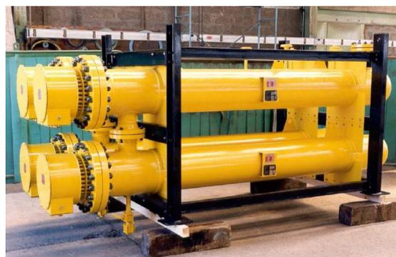
Удельная мощность для фланцевых погружных нагревателей может составлять от 0,1 до 40 Вт/см<sup>2</sup>, и зависит от рабочих условий процесса (среда, расход, давление), от коэффициента теплоемкости и теплообменных свойств нагреваемой среды. Максимальная мощность, передаваемая одним фланцевым нагревателем, может достигать нескольких МВт.
