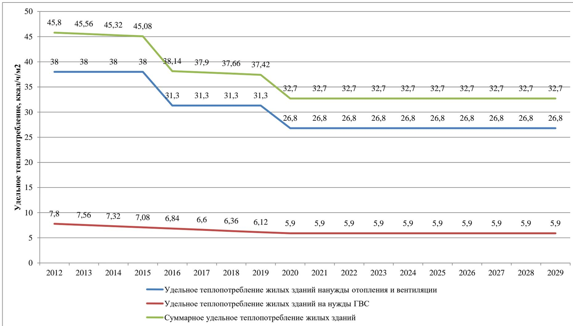
Рисунок 2.6 - Динамика изменения удельного теплосодержания жилого здания
