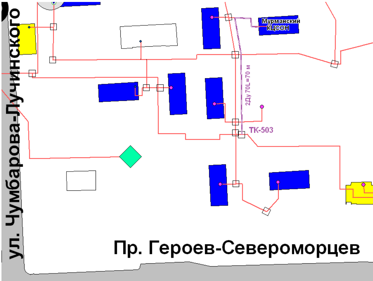
Рисунок 7.25 Предложения по организации закрытой ГВС в зоне ЦТП №2
