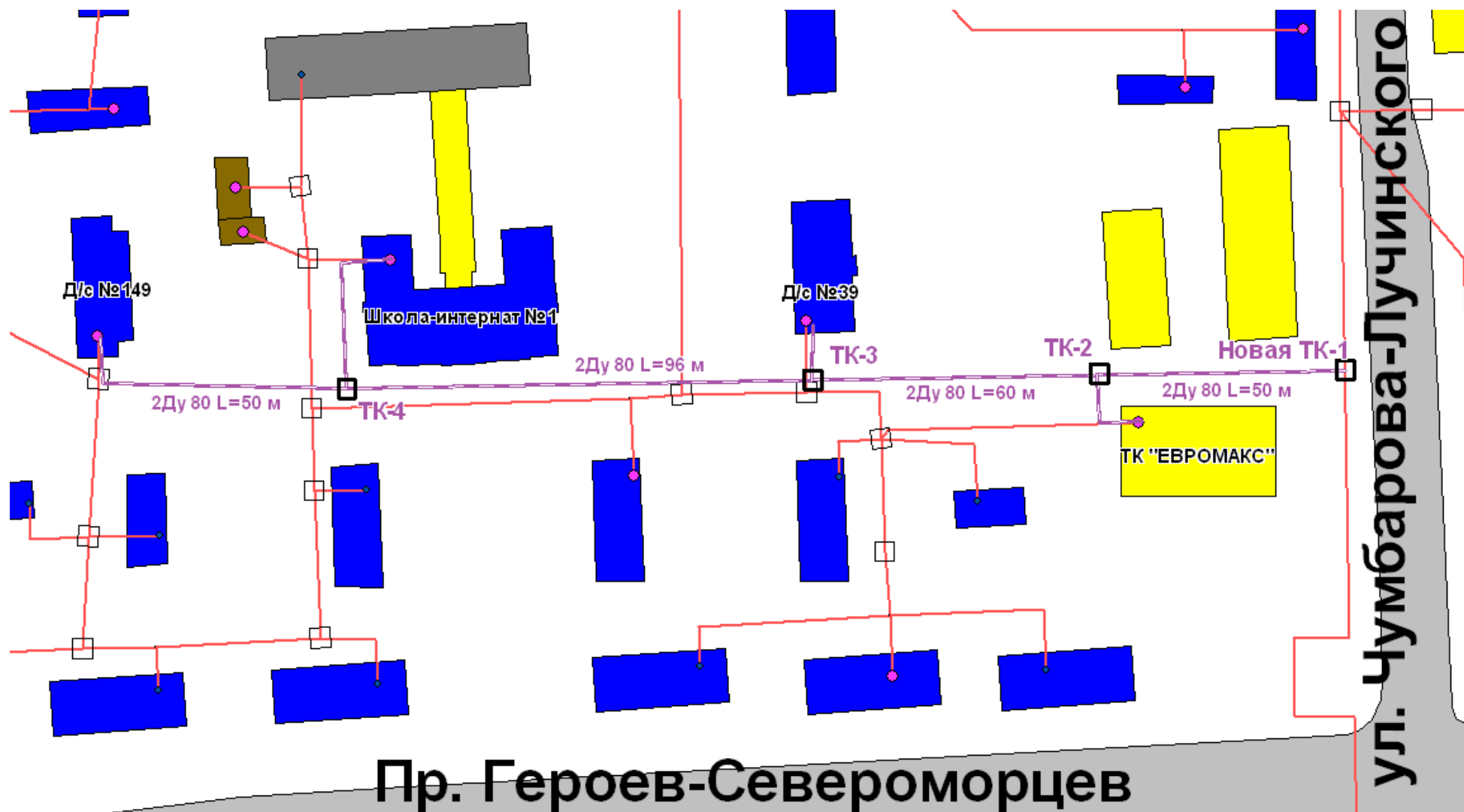
Рисунок 7.24 Предложения по организации закрытой ГВС в зоне ЦТП №1
